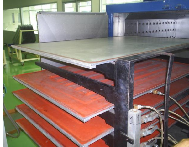
รูปที่ 1.5 แสดงแผ่นลามิเนตที่ประกอบด้วยแผ่นกระจก ชั้นวัสดุกึ่งตัวนำและแผ่นฟิล์มอีวีเอที่กำลังจะเข้าเครื่อง vacuum thermoforming เพื่อขึ้นรูป
