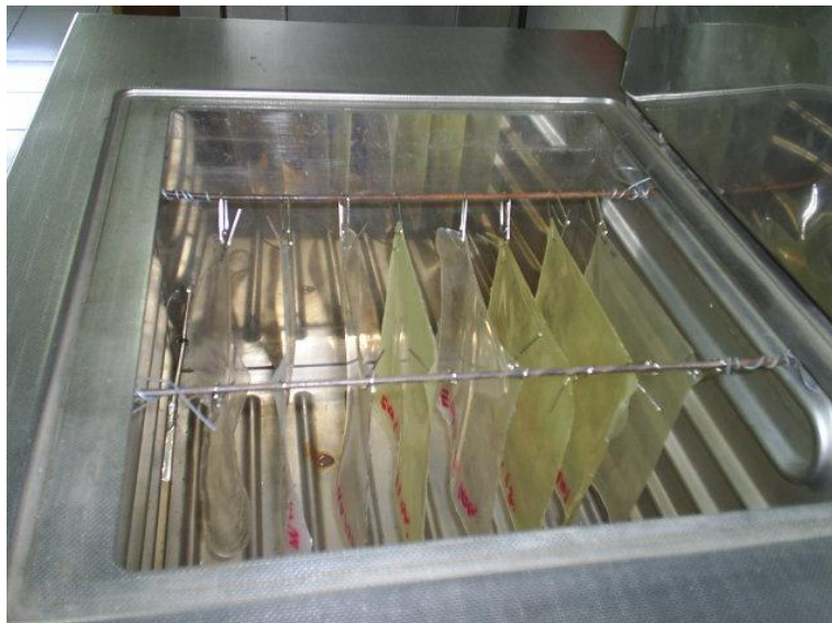
รูปที่ 1.6 แสดงลักษณะการวางชิ้นงานในเตาอบเพื่อทดสอบสมบัติด้านการทนความร้อนของฟิล์มอีวีเอ
