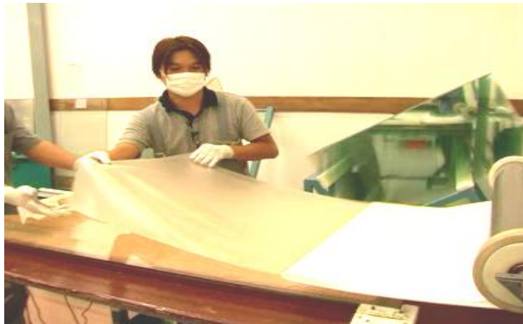
รูปที่ 1.2 การประกอบแผงเซลล์แสงอาทิตย์โดยใช้ฟิล์ม EVA เป็น encapsulating material [ภาพจาก บริษัท Bangkok Solar จำกัด]
